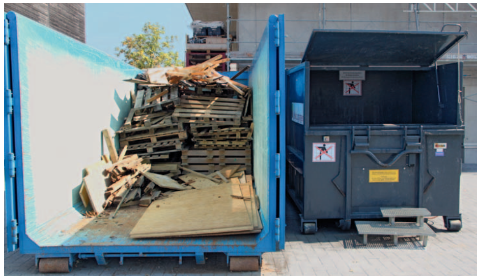
Presscontainer für KVA-Abfälle und Holzmulde (36 Kubikmeter) reduzierten die LKW-Fahrten pro Jahr um 30 Stück.
